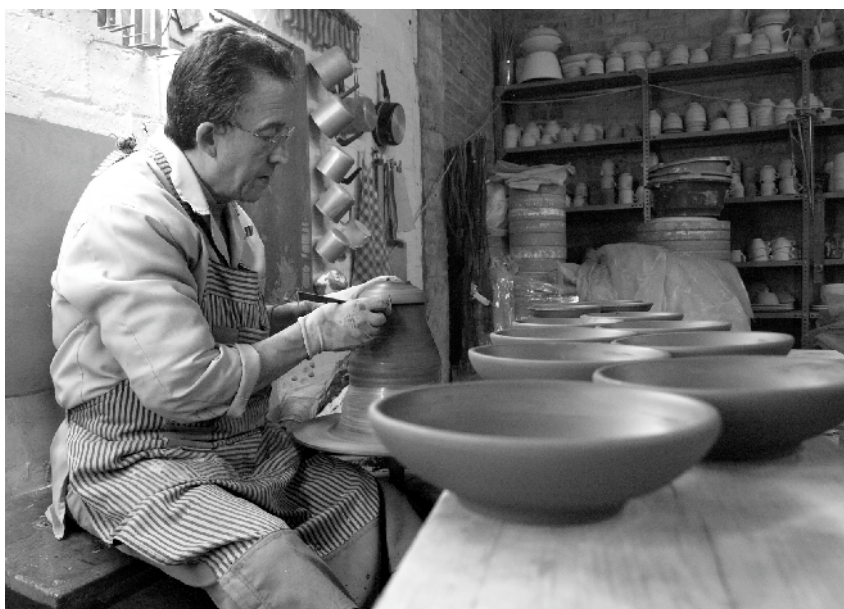
Enric Grasiot llimant i polint un cendrer amb ferrussa al taller del carrer Tramuntana, 22. Any 2010. Autor: Ferran Vilà-Clara Grasiot. Procedència: arxiu família Vilà-Clara.
